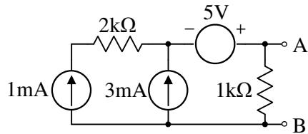
**2. a)** [22] Primenom **metode potencijala čvorova** izračunati potencijale svih čvorova u kolu sa slike, kao i struje  $I_A$ ,  $I_B$  i  $I_C$ .
